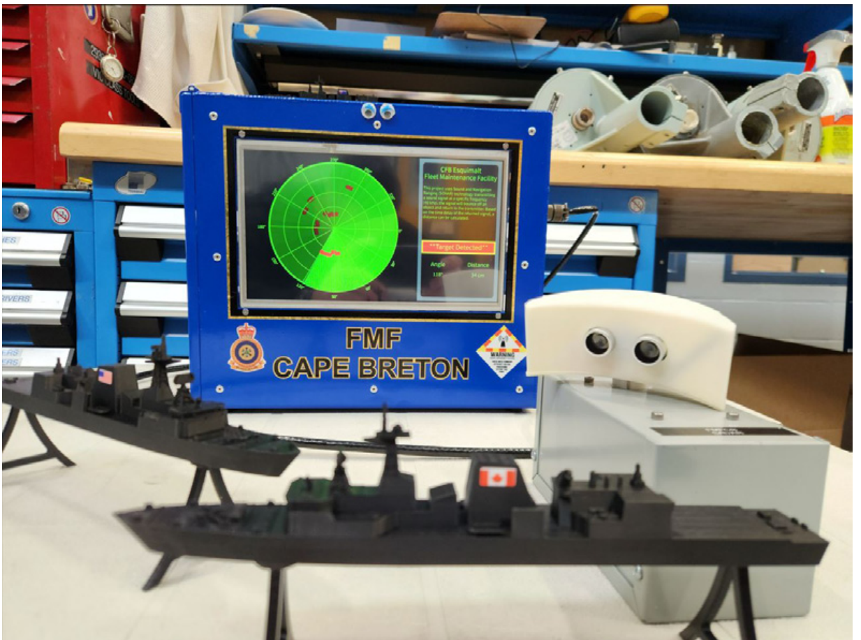
Gros plan sur le SADAR : divers objets sont placés à proximité du SADAR pour montrer comment le système localise avec précision l'emplacement et la position des cibles environnantes. Photo : Mike Knippel, responsable de la stratégie : Mike Knippel, responsable de la stratégie
