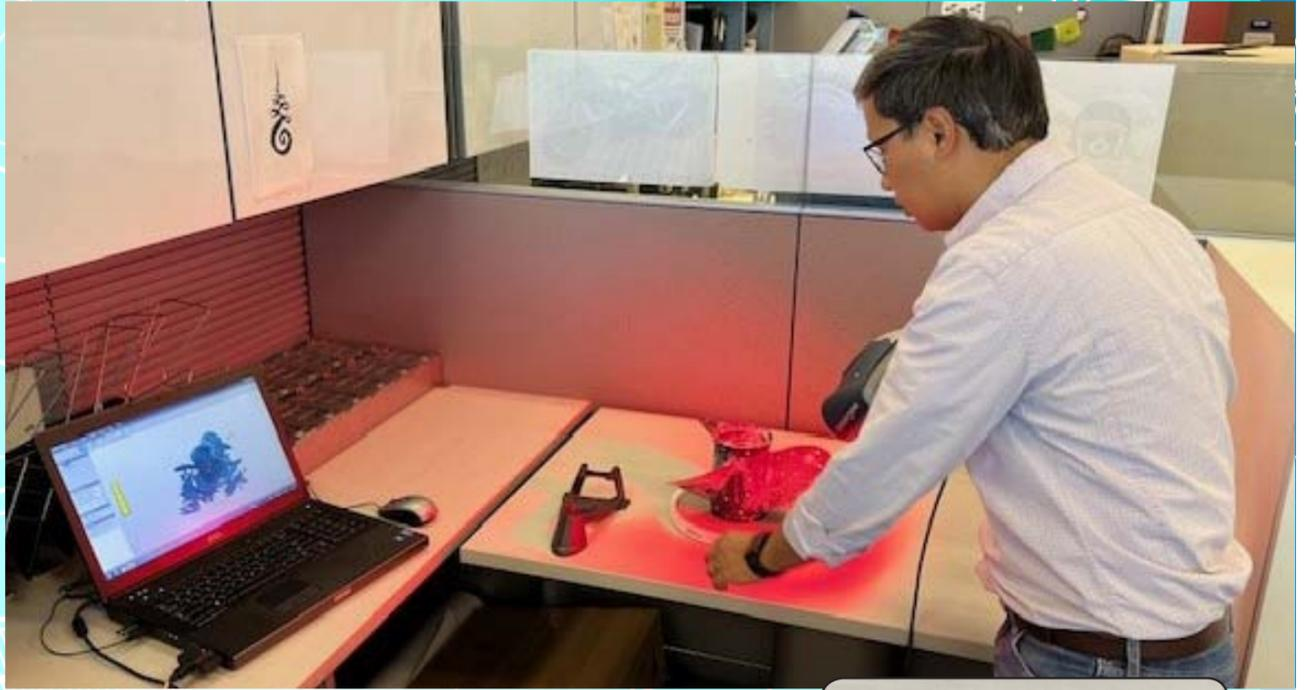
Si Thu Naing, superviseur du bureau de dessin au sein de la sous-section de l'architecture navale de l'Installation de maintenance de la flotte du Cap-Breton, forme un étudiant en génie mécanique du College Camosun à la capture de données de nuages de points en 3D à l'aide du scanner portable CreaForm 3D. (en médaillon) Prototype d'engrenage sectoriel à quart de tour capturé à l'aide du scanner CreaForm. Photos soumises
